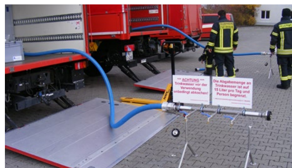
Abbildung 14: Trinkwasserausgabe bei der Feuerwehr (Bildquelle: Reuber, 2018)
