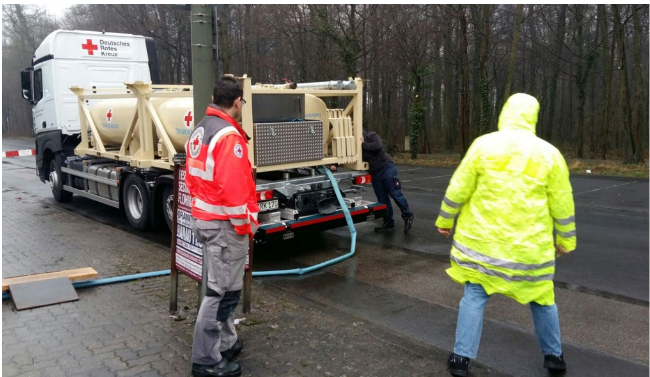
Abbildung 12: Überbrückung von Leitungsabschnitten durch Transport des Trinkwassers mittels Transportfahrzeugen (Bildquelle: DRK-Landesverband Hessen)
