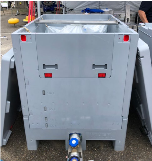
Abbildung 25: Speicherbehälter mit Einweg-Inlet (Bildquelle: SWA)
