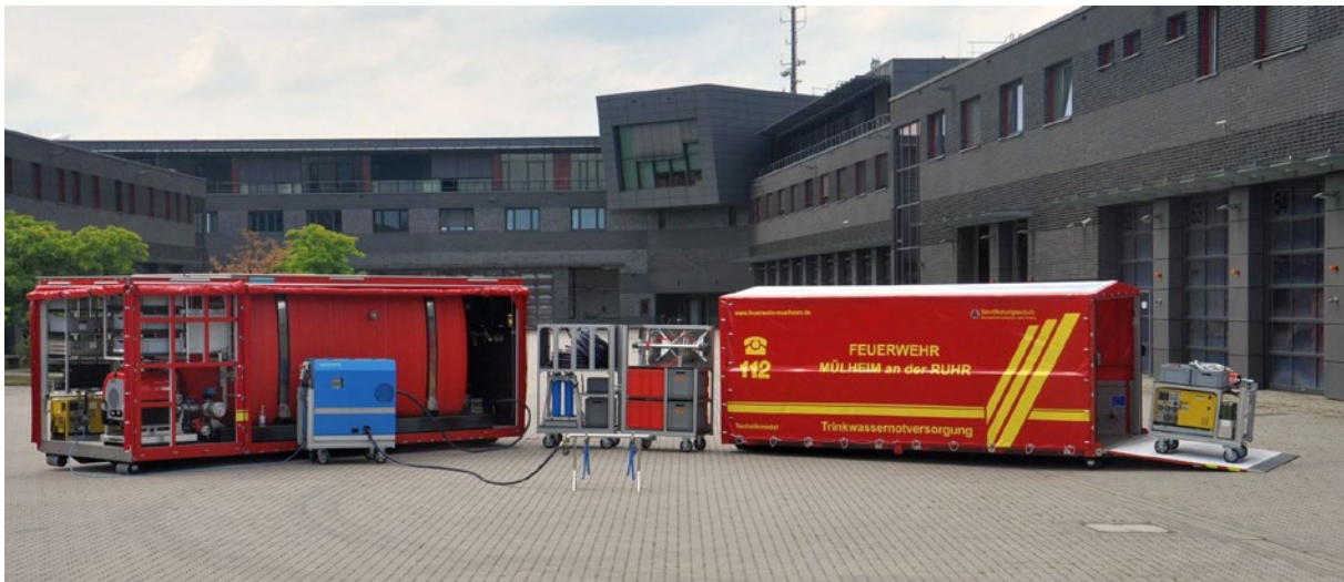
Abbildung 35: exemplarischer Systemaufbau des Modulsystems „Trinkwassernotversorgung“ der Berufsfeuerwehr Mülheim an der Ruhr (Bildquelle: Lülff, 2019)
